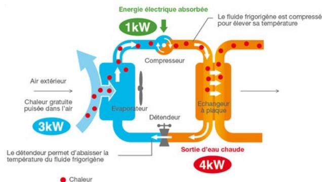
La **PAC air/ eau** est un dispositif qui génère de la chaleur en utilisant les molécules de l'air comme source. La façon dont la pompe à chaleur produit de l'énergie thermique à partir de l'air peut être facilement décrite à l'aide de l'exemple d'un réfrigérateur. Le principe de fonctionnement d'une **PAC air/eau** repose sur la récupération des calories dans l'air extérieur, leur transformation en chaleur, cette dernière réchauffer l'eau à diffuser dans les canaux du chauffage.
